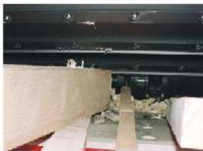
Les nouvelles traverses crantées des tambours garantissent une prise de matière optimale et une alimentation constante vers le rotor. Cet ensemble d'alimentation fonctionne selon la puissance absorbée du moteur et s'arrête automatiquement en cas d'excédent de matière. Le rotor peut ainsi continuer à broyer sans encombre et n'est pas surchargé.
