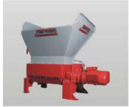
Série RMZ 500 - RMZ 1000 S, broyeur à quatre axes, idéal pour le broyage de longs morceaux
