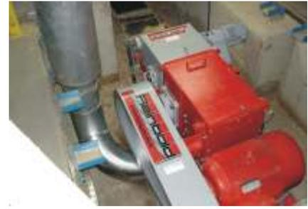
Broyage de déchets de bois d'une scie à plaques par un broyeur horizontal RHZ 400 S enterré
