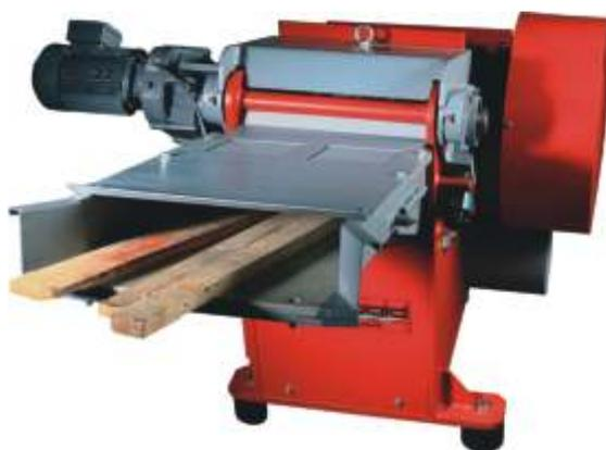
Notre petit broyeur RLZ super puissant peut être utilisé pour toutes les applications, par exemple à côté d'une scie de découpe de plaques, d'une scie multilames, etc. Le RLZ convient également au broyage d'autres matériaux, tels que les profils en plastique et les lattes.
