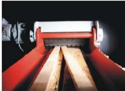
La série RHZ de Reinbold est dotée de détails astucieux : deux tambours d'alimentation à traverses crantées assurent une meilleure alimentation des matières et facilitent le chargement des machines.
