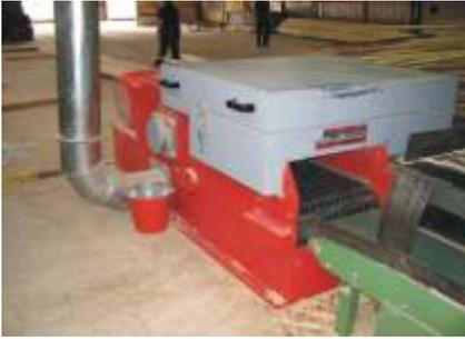
Avec chargement à chaîne spécial et raccordé à une aspiration
